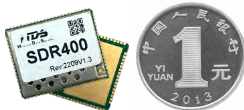
实际大小，重量仅 5 克！ 26.5x33x3.5mm (TTL, 3.3/3.6V)
