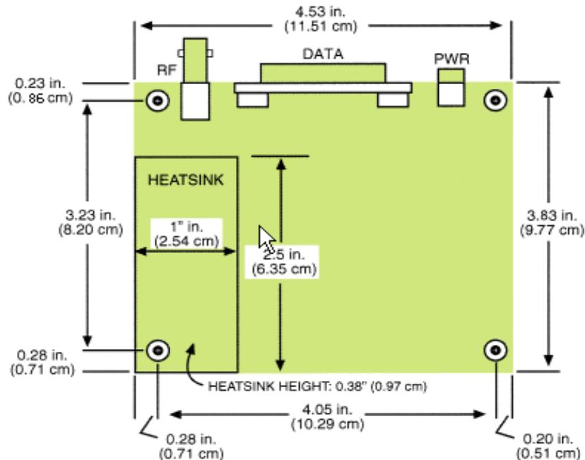
图7 电台安装尺寸(单板模块)
