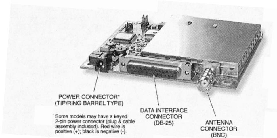
图 6 电台单板模块的外部连接
