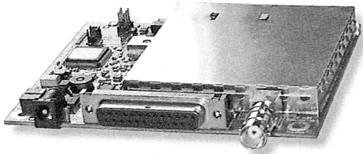
图 1 EL7051/EL7052/EL7054 系列数传电台(单板模块结构)
